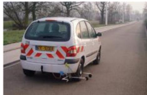
Figure 2.41 : Mesure du bruit de roulement en continu, [4].
