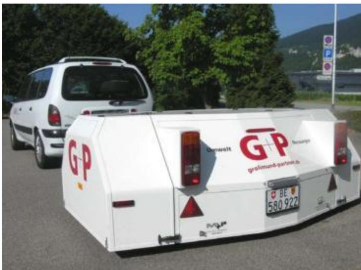
Figure 2.37 : Remorque de mesure CPX, [2].
