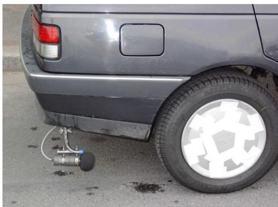
Figure 3.14 : Mesure du bruit de roulement en continu, [47].
